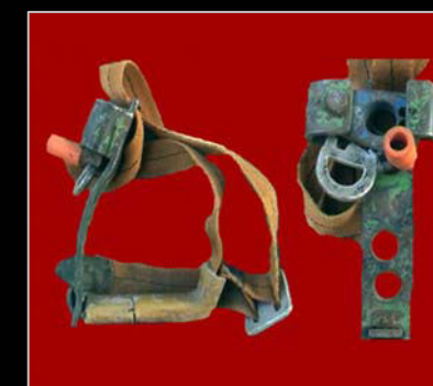
1987. Bloqueador de pié Muñoz de fabricación casera en hierro pintado. Diseño y construcción: A. Muñoz, R. Belmonte y P. Galo.
