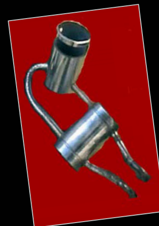
1975. Freno Galo. Invento de construcción casera para rapelar.
