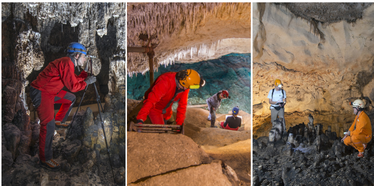
Figura 5: Esquerra, espeleòleg prenent orientacions per a la confecció de la poligonal principal a la cova Negra. Centre, espeleòlegs a la vora del Llac de les Meravelles mentre es dibuixa el plànol. Dreta, espeleòlegs prenent mides a la cova Blanca (Fotos: M. À. Gual). Figure 5: Left, caver taking orientations for the main polygonal in the Cova Negra. Center, cavers near the Llac de les Meravelles while drawing the survey. Right, cavers measuring the Cova Blanca (Photos: M. À. Gual).
