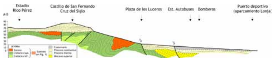
Figura 2. Corte geológico en el centro del casco urbano de la ciudad de Alicante. Localización indicada en la figura 1.
