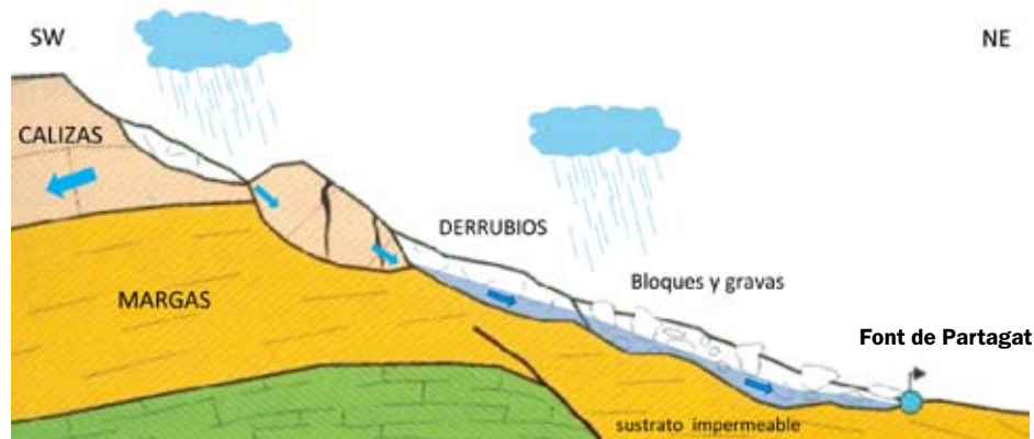
figura 17 - Funcionamiento de la Font de Partagat, con indicación del flujo del agua subterránea.
