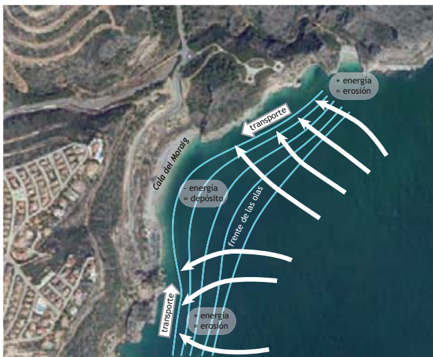
En la parte inferior: fotografía aérea de la cala del Moraig en la que se indica la mayor energía del oleaje en los salientes rocosos del acantilado, y la menor energía en la cala, lo que permite el depósito del sedimento, principalmente grava. Esquema modificado de Laignère et al. (2004).
