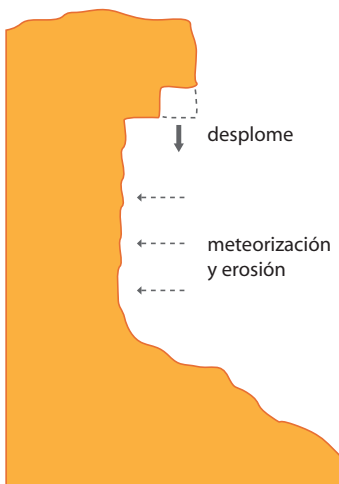
figura 16 - Esquemas y fotografías de los tipos de roturas existentes.
