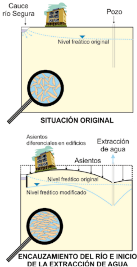
figura 36 - Esquema conceptual del origen de la subsidencia del terreno en la ciudad de Orihuela.
