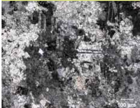
figura 38 - Aspecto de la roca dolomítica negra en Microscopio Óptico Petrográfico iluminada con luz polarizada cruzada.
